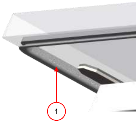
Figure 15: Remplacer le joint de couvercle
