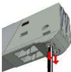
Figure 12: Enlever la barre de soudure
