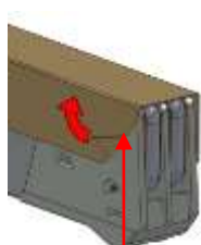
Figure 12: Enlever la barre de soudure
